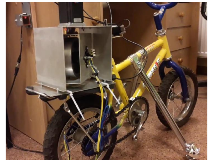
Stabilizacja jednoślada za pomocą koła zamachowego
