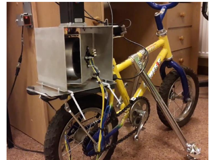
Stabilizacja jednoślądu za pomocą koła zamachowego
